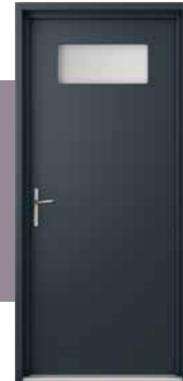
Porte de service vitrée Triple vitrage feuilleté dépoli. Nombreuses finitions de vitrages en option. Ouvrant ép 60 mm. Vitrage affleurant. Ud = 0.7
