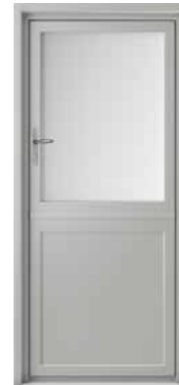
Porte fermière traditionnelle PVC Petit bois incorporé au vitrage couleur titane. Possibilité d'ouvrir la partie haute uniquement. Verre dépoli. Paumelles 2D en option. Ud PVC : 1.2
